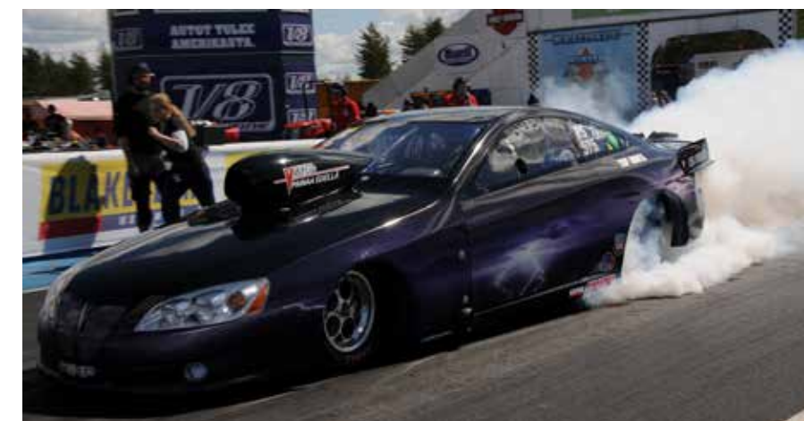
Auton takarenkaat lämmitetään ennen jokaista lähtöä, mikä takaa optimaalisen pidon lähtöhetkellä.
